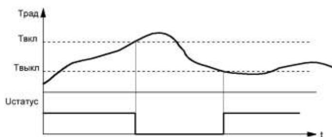
Рисунок 3 – Диаграмма функционирования температурной сигнализации
