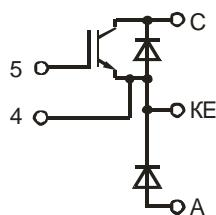
Рисунок 2 – Электрическая схема внутренних соединений модуля
