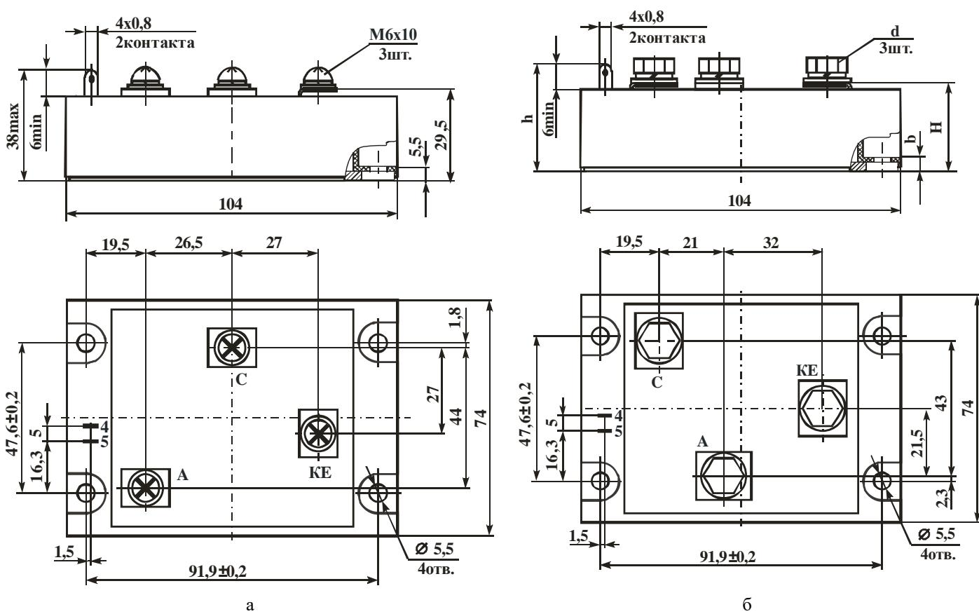
Неуказанные предельные отклонения присоединительных размеров  $\pm 0,5$  мм
