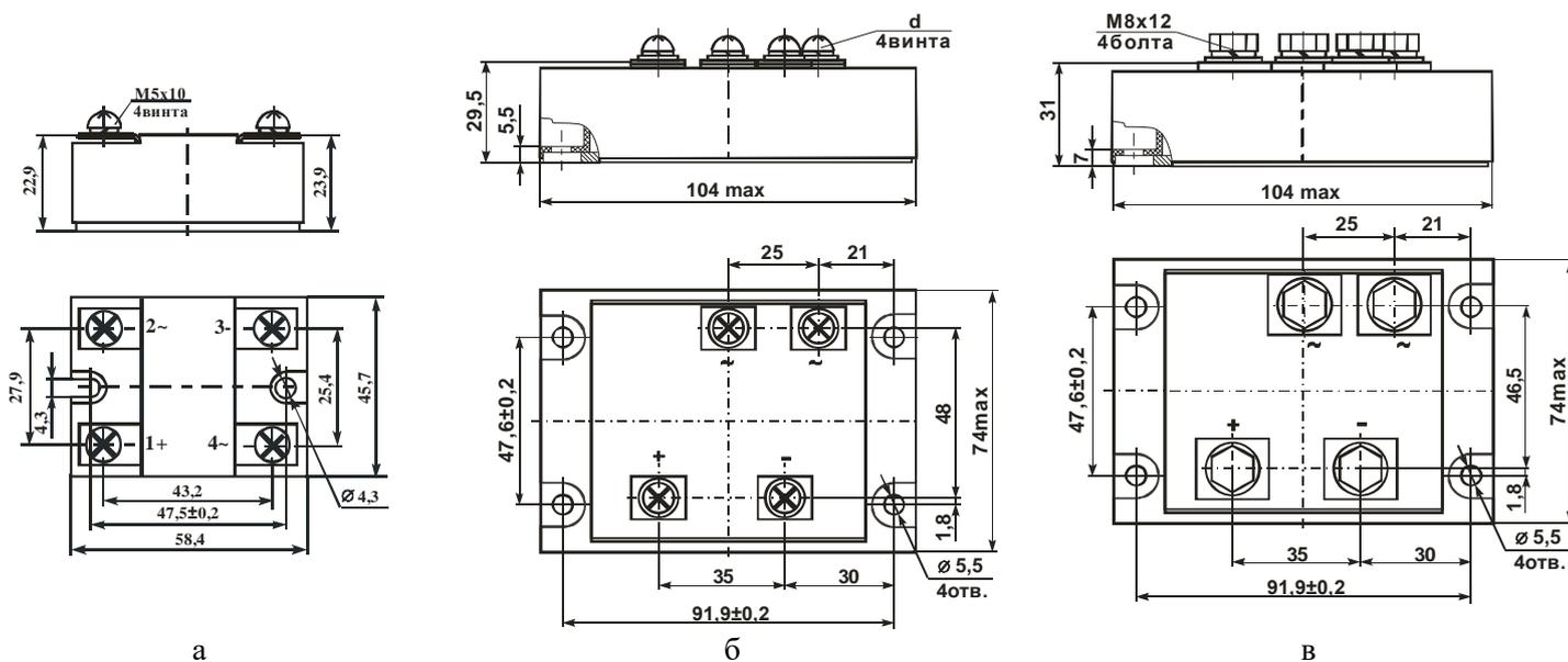
Неуказанные предельные отклонения присоединительных размеров  $\pm 0,5$  мм
